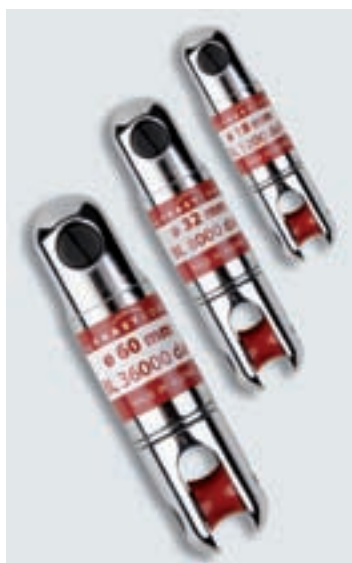
dispositivo de acero cromado con cojinete axial y ojete para eliminar la torsión entre la malla tiracables y el cable del cabrestante
